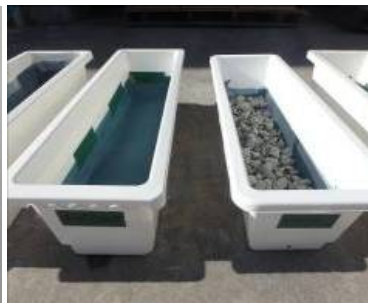
くるストシートの下に入れた場合とシートの上に入れた場合で比較試験中です
