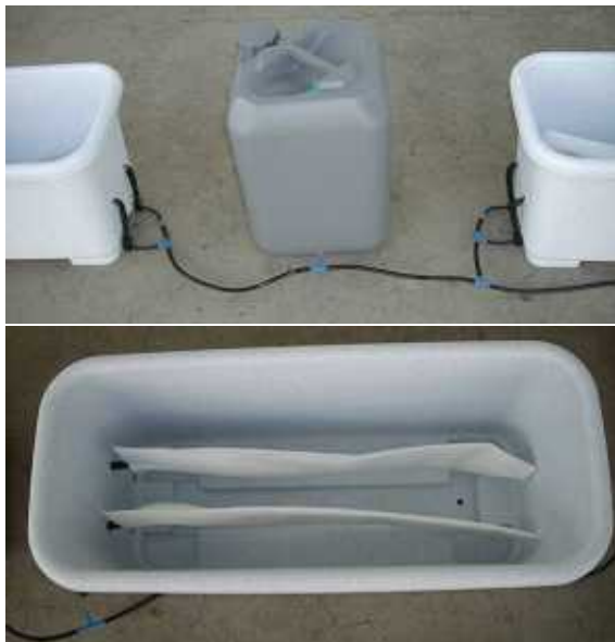
外に置いたタンクとプランター内の給水マットをつなぐ方式
